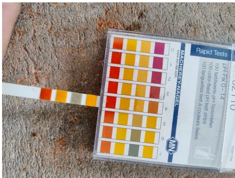
Fot 5.15 – wyjściowa wartość pH = 6÷7 próbki pobranej w punkcie K
