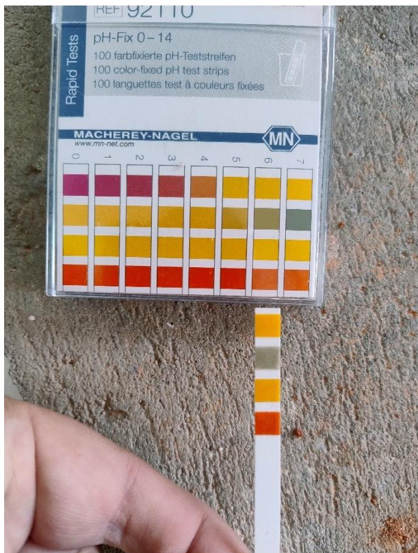
Fot 5.7 – wyjściowa wartość pH próbki pobranej w punkcie 6
