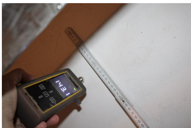
fot 5.4 – pojedyncze odczyty nieinwazyjnego mapowania wilgoci w p. 6
