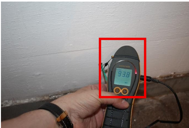
fot 5.5a – pomiar wilgotności masowej w p.1 – wartość > 12% (poza zakresem tabeli regresji)
