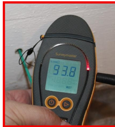
fot 5.5a – pomiar wilgotności masowej w p.1 – wartość > 12% (poza zakresem tabeli regresji)
