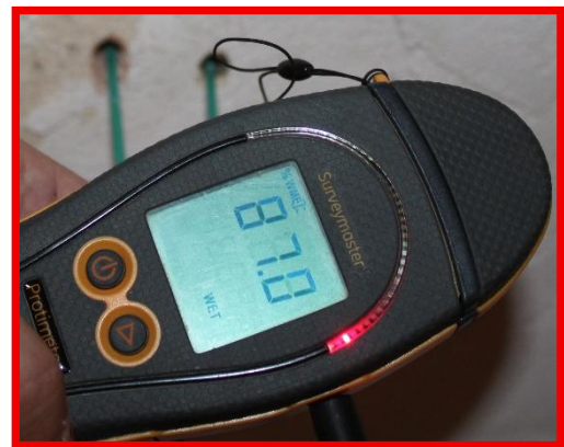
fot 5.5b – pomiar wilgotności masowej w p.6 – wartość > 12% (poza zakresem tabeli regresji)
