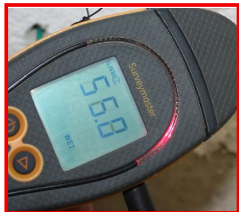
fot 5.5c – pomiar wilgotności masowej w p.14 – wartość > 12% (poza zakresem tabeli regresji)
