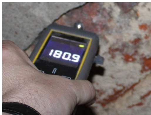
fot 5.11 – 5.14 - Odczyt wilgotnoścomierza Trotrec T660 wskazuje na mokrą ścianę (maksymalny odczyt 200"digits")
