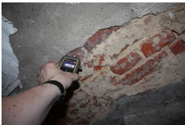
fot 5.11 – 5.14 - Odczyt wilgotnoścomierza Trotrec T660 wskazuje na mokrą ścianę (maksymalny odczyt 200"digits")
