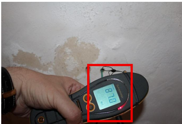
fot 5.5b – pomiar wilgotności masowej w p.6 – wartość > 12% (poza zakresem tabeli regresji)
